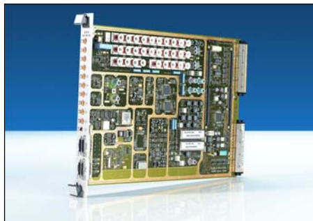
2. ábra. R&S EM010 és R&S EM050 RH és VHF/UHF, VXI interfész-alapú vevőmodulok a R&S AMMOS rendszerhez
